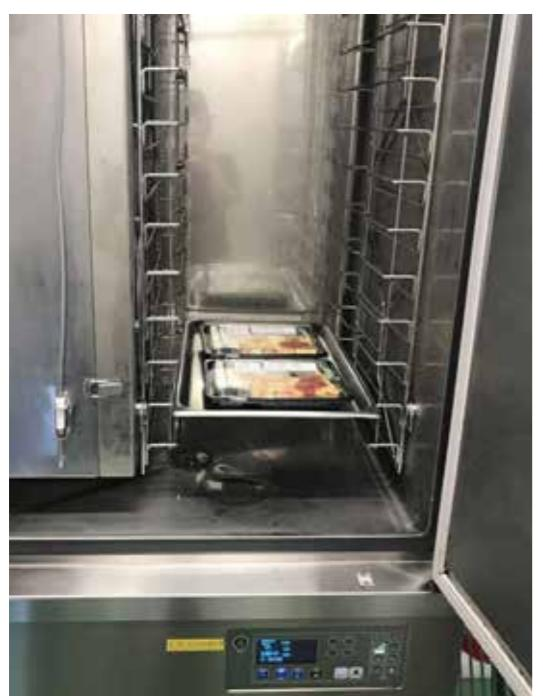
調理後は「チルプラスト」で急速冷却し、菌の繁殖を抑制
